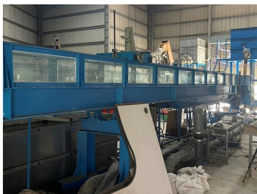
圖 8 土砂啟動實驗設備整體側視照
