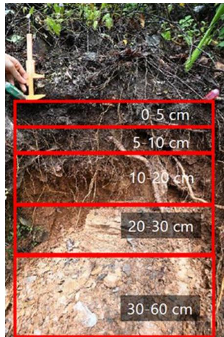
圖4 剖面法挖掘的土壤剖面
