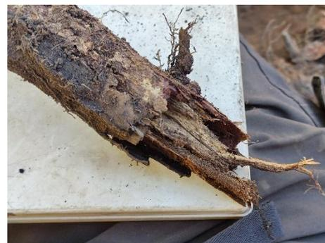
圖8 試驗後拔出的根段
