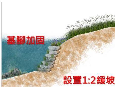
圖9堤岸設施補強處理對策示意圖
