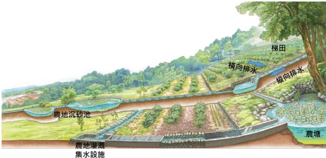
圖10 既有水路串聯示意圖(水土保持局，2014)
