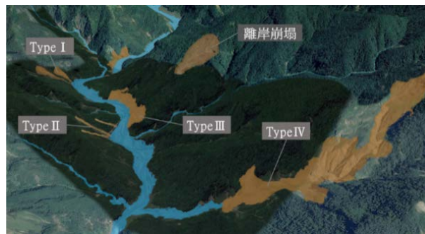
圖 4 研究區不同類型之近岸崩塌與離岸崩塌 Fig. 4. Classification of near-bank and off-bank landslides in the study area.
