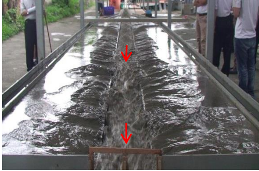
圖 8 深槽沖刷與側灘淤泥崩落現象
