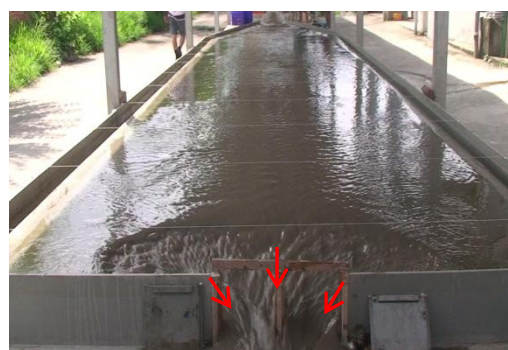
圖 14 試驗初期出口洩降沖刷現象
