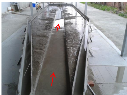
圖 12 試驗後期沖淤情形
