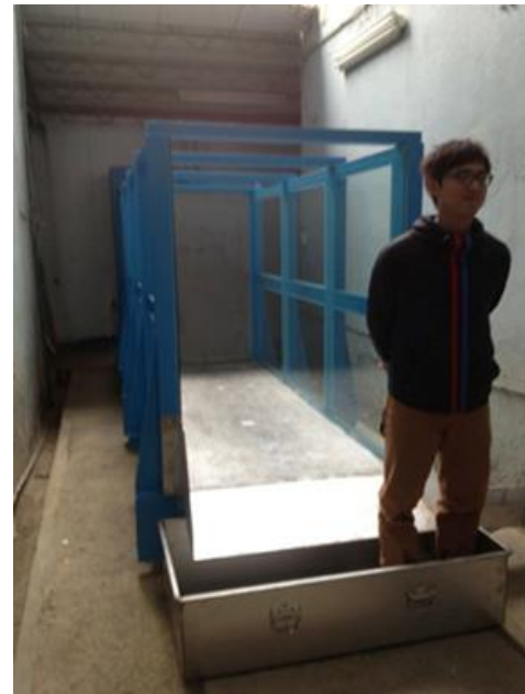
圖 3 邊坡模型設備
