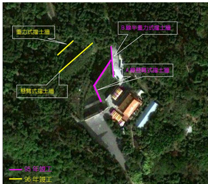
圖 7 研究試區擋土牆工程配置圖
