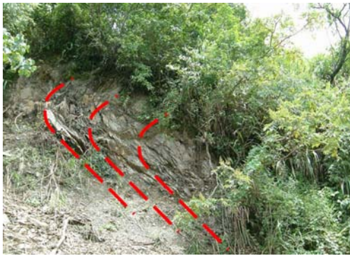
圖 9 廬山地區的板岩地表潛移現象 Figure 9. Surface creep phenomena of Lushan slate
