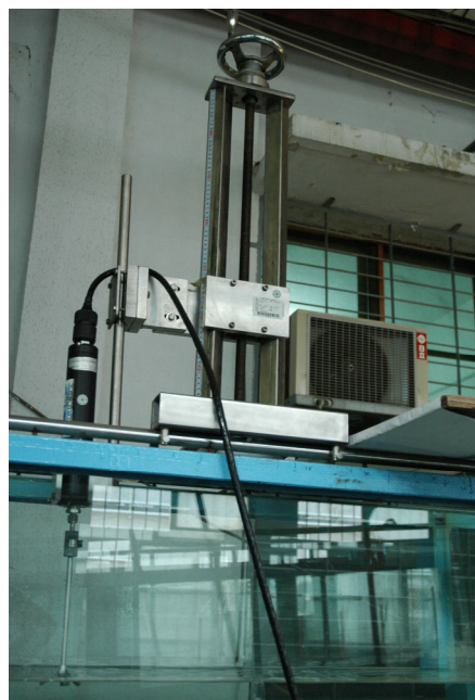
圖 4. 以可動式支架調整 ADV 位置
