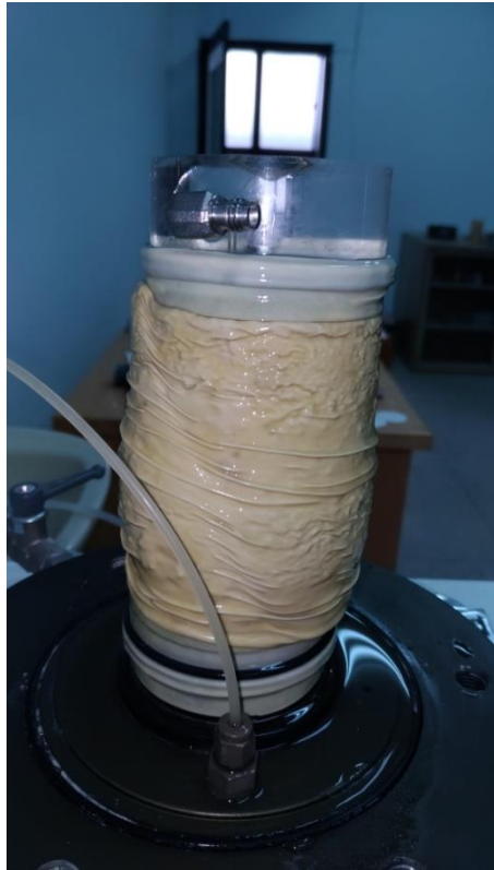
圖 13 過壓密黏土 4 破壞後照片
