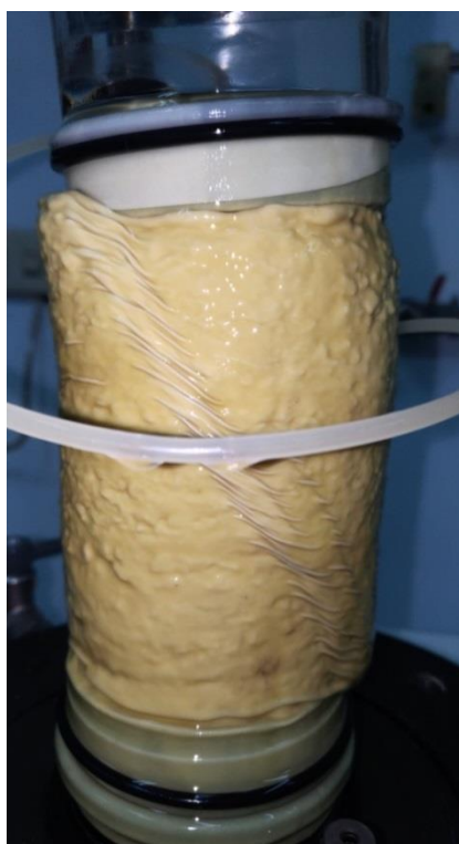
圖 12 過壓密黏土 3 破壞後照片
