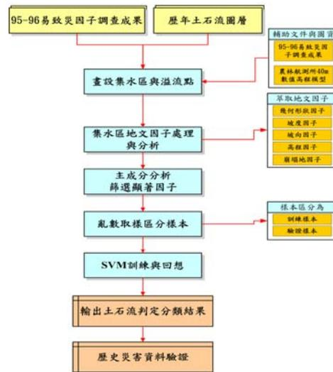
圖 5 土石流潛勢溪流判定模式建立流程
