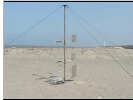
圖 3 BSNE 集砂器 Figure 3 BSNE sampler
