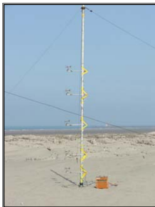
圖 2 多層風速計 Figure 2 The multi-layer anemometer of wind velocity
