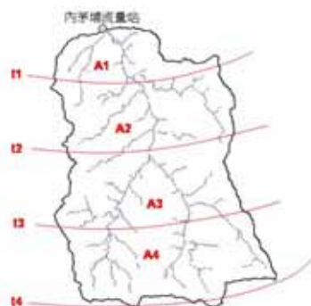
圖 4. 等集流時間線概念示意圖 Figure 4. Isochrones time of concentration.
